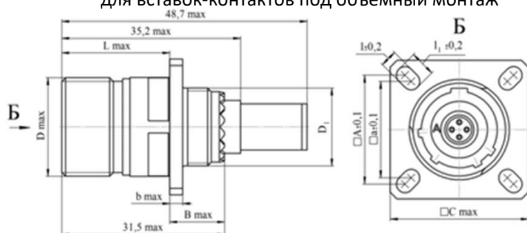
Вилка (Розетка) приборного исполнения для вставок-контактов под объемный монтаж
